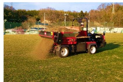
写真 8. 目砂散布機械（保有）【近景】
