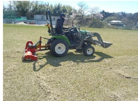
写真 4. バーチカルカット機械（外注）【近景】
